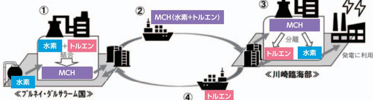
① 製造した水素にトルエンを結合させ、MCH(メチルシクロヘキサン)に変換することで常温・常圧で液体になります。
