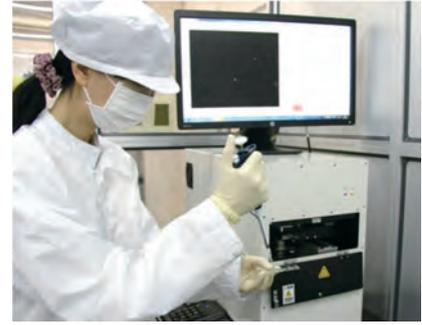
PDMS製のマイクロ流路チップとレーザー暗視野顕微光学系で構成される。流路の側方からシート状に成形したレーザー光を入射し、流路内の粒子で生じた散乱光を流路下方の対物レンズで集光し、高感度カメラで結像して高コントラストの暗視野像を得る。暗視野イメージング<sup>\*4</sup>では一般的な透過光を用いる照明法では検出することのできない、光の回折限界以下のサイズのナノ粒子を個々に検出することができる。
